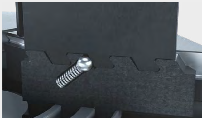
Odpružená přitlačná kulička v těle sklíčidla zajišťuje napnutí čelisti.
