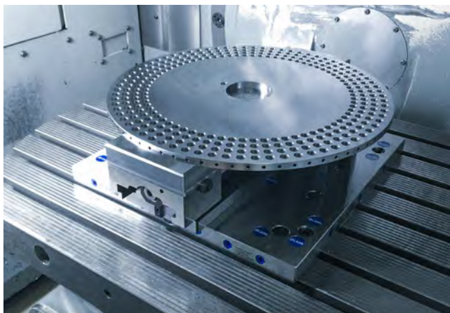
Velikost dílu: Ø 420 × 10 mm, Materiál: 1.7131, Makro-Grip® Ultra základní sada 410 S s čelistmi Avanti
