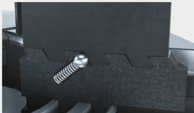
Odpružená přítlačná kulička v těle sklíčidla zajišťuje napnutí čelistí.
